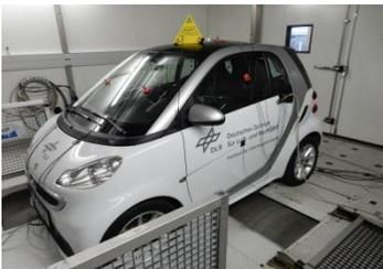
Reichweitenuntersuchungen an einem Elektrofahrzeug
