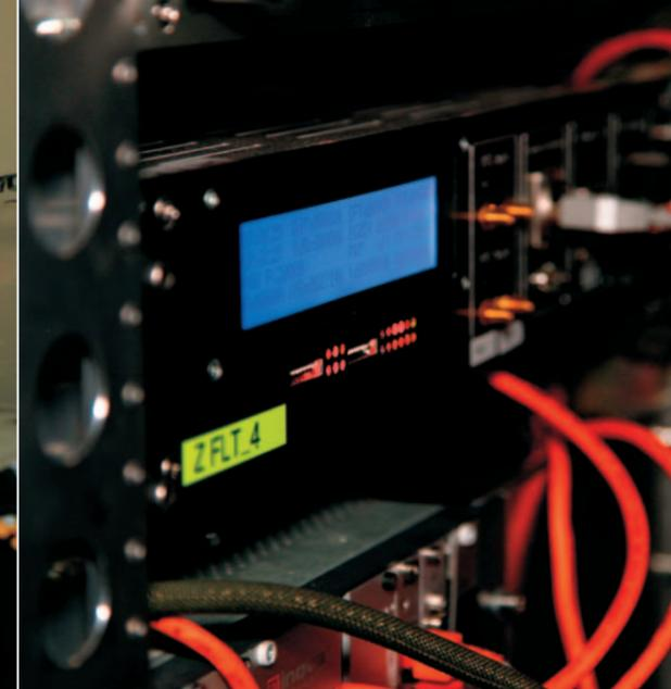
Laser Ethernet Transceiver (LET) im Inneneinbau. Hier werden die Nutzdaten (z. B. Kamerabilder, Radaraufnahmen) in ein für die Freistrahübertragung optimiertes Sendedatenformat gewandelt.
