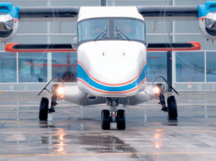
Das DLR-Forschungsflugzeug Do 228-212 beim Testbetrieb des Experimentaleinbaus zur optischen Kommunikation. Der Außenbau des Laserterminals befindet sich links unten am Rumpf.
