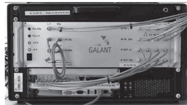
Das Oberpfaffenhofener DLR-Institut entwickelt unter anderem robuste Empfänger, die unempfindlich gegen Störsignale sind
