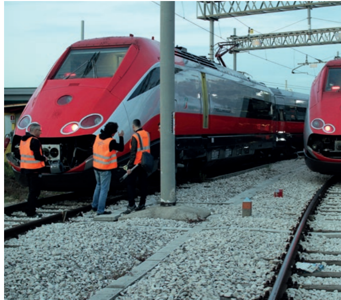
Die beiden Frecciarossa-Hochgeschwindigkeitszüge erreichen eine Höchstgeschwindigkeit von 360 Kilometern pro Stunde und haben eine Länge von 328 Metern. In ihren Spitzen installierten die Wissenschaftler Messantennen und Abstandsradar, um die Distanz der zwei Züge genau zu ermitteln und Informationen zwischen den Zügen auszutauschen.
