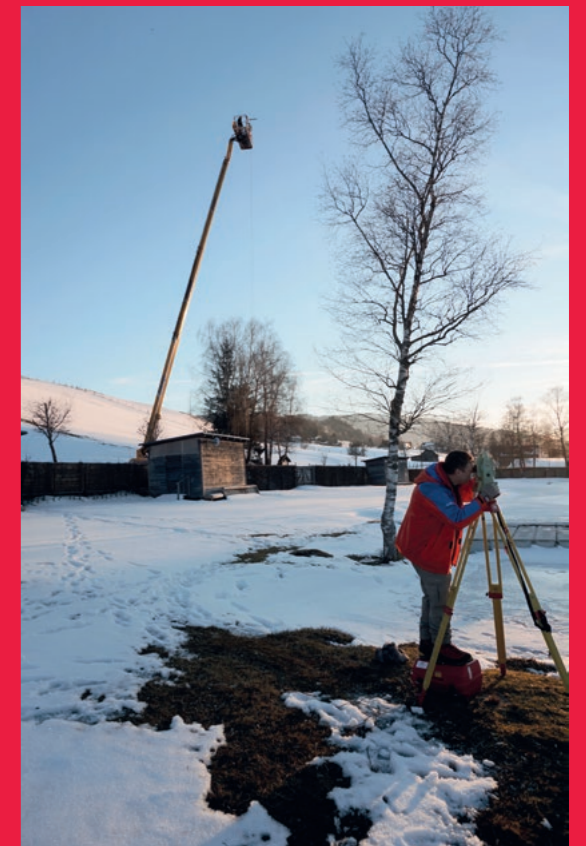
Um die Bodenreflexionen eines Funksignals zu messen, das von einem Flugzeug oder einem Satelliten ausgestrahlt wird, installierten die Wissenschaftler für Versuche 2014 und 2015 den Channel Sounder auf einem 40 Meter hohen Kran
