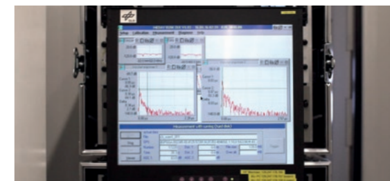
Der Channel Sounder besteht aus einer Sende- und einer Empfangseinheit. Der Empfänger zeigt, wie das Funksignal durch die Umgebung reflektiert wird.
