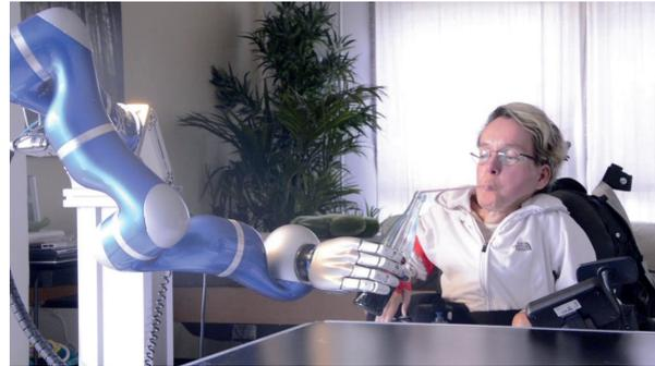
Über diese EMG-basierte Schnittstelle kann sowohl der Rollstuhl, wie auch der Leichtbauroboter gesteuert werden. Um die Funktionalität weiter zu erhöhen, verfügt EDAN über ein Ganzkörper-Steuerungskonzept. Diese Ganzkörpersteuerung ermöglicht die Realisierung komplexer Aufgaben, die eine zeitgleiche Koordination von Arm und Rollstuhl erfordern, wie es z. B. beim Öffnen und Durchfahren einer Tür notwendig ist.
