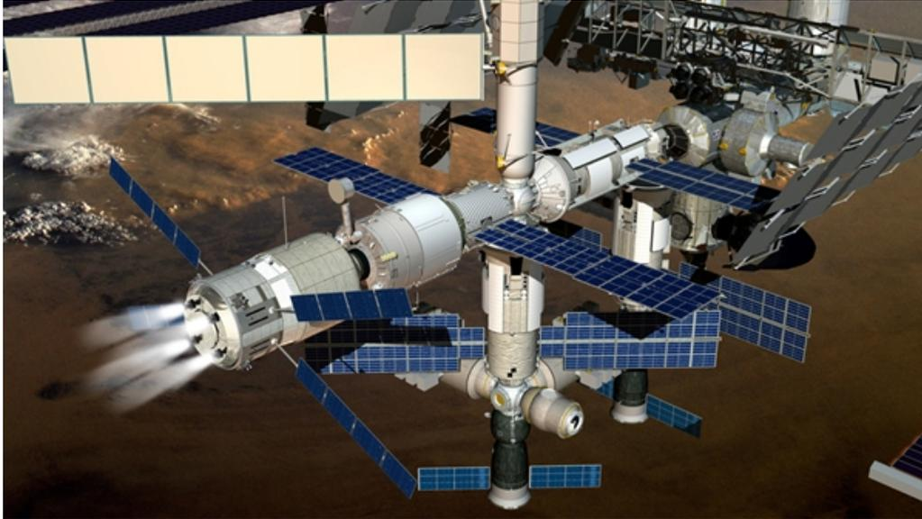
Die Triebwerke des ATV sind in der Lage die Internationale Raumstation ISS in eine höhere Umlaufbahn anzuheben. Die ISS wird durch die dünne Restatmosphäre in ihrer Umlaufbahn permanent gebremst und verliert an Höhe. Das ATV bringt bis zu 4,7 Tonnen Treibstoff zur Bahnkorrektur mit ins All.
