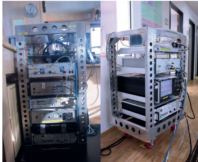
Der Channel Sounder im Einsatz: links die Sendeeinheit und rechts die Empfangseinheit
