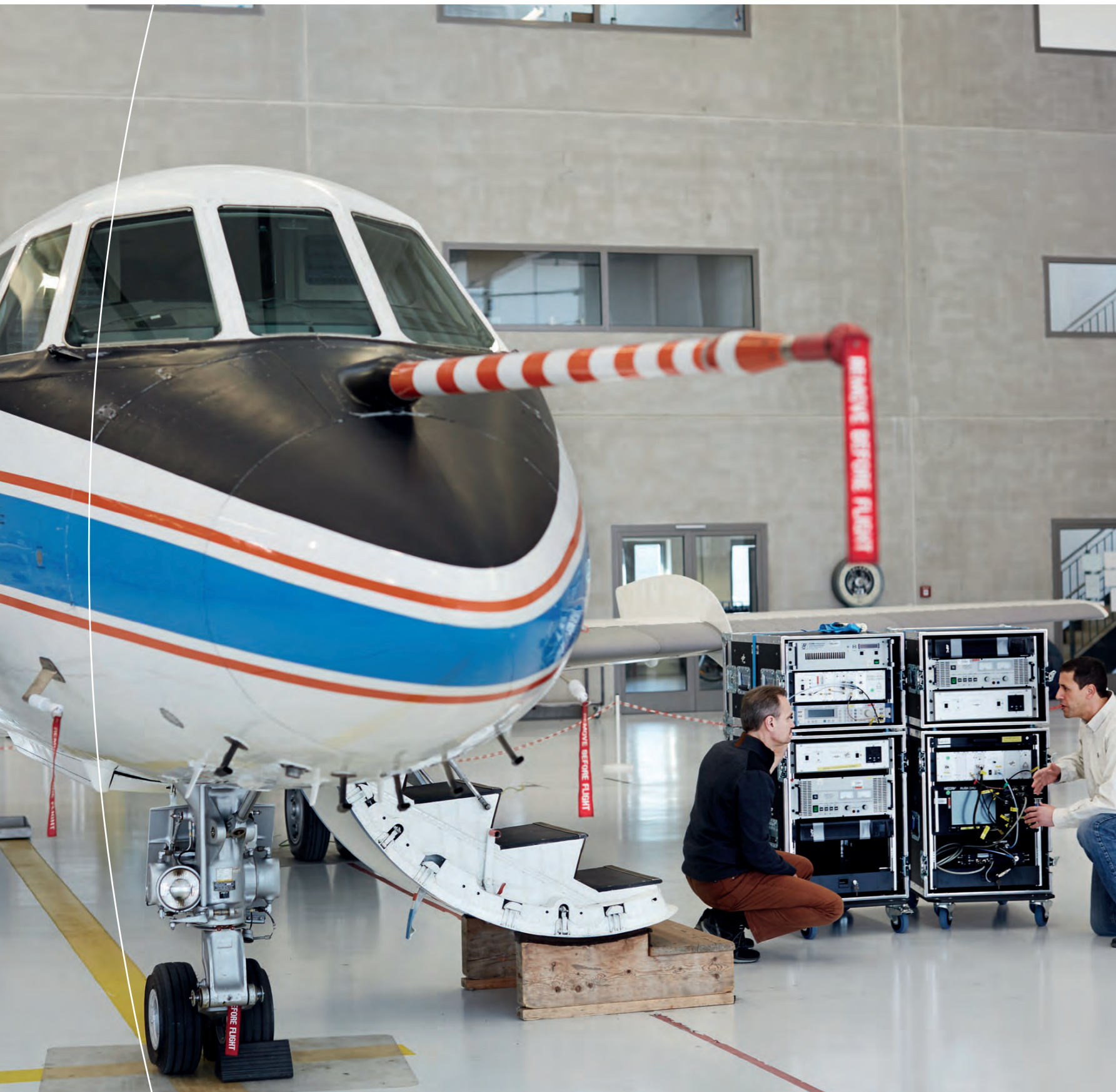
Mit hochpräzisen Messinstrumenten in der Luft: der Channel Sounder vor dem Einbau in das DLR-Forschungsflugzeug Falcon im Hangar des DLR in Oberpfaffenhofen
