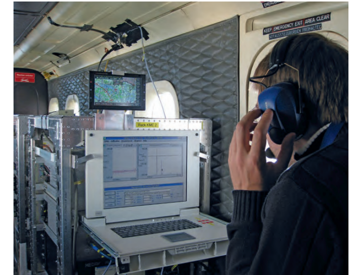
Der Channel Sounder in der Luft, unterwegs im DLR-Forschungsflugzeug Dornier Do 228
