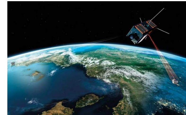
Mit der sogenannten Quantenkryptografie lassen sich Daten abhörsicher verschlüsseln. Das DLR erforscht unter anderem auch optische Kommunikationssysteme für Kleinsatelliten wie hier bei PIXL-1.
