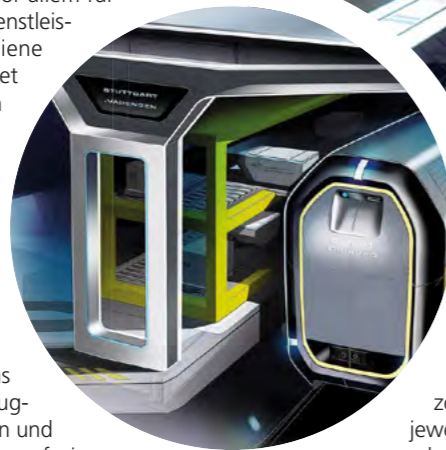
Regallager im Logistics-Terminal-Konzept sind entlang der Zugwagen positioniert. Güter werden automatisch vorsortiert und direkt am Gleis zwischengelagert.
