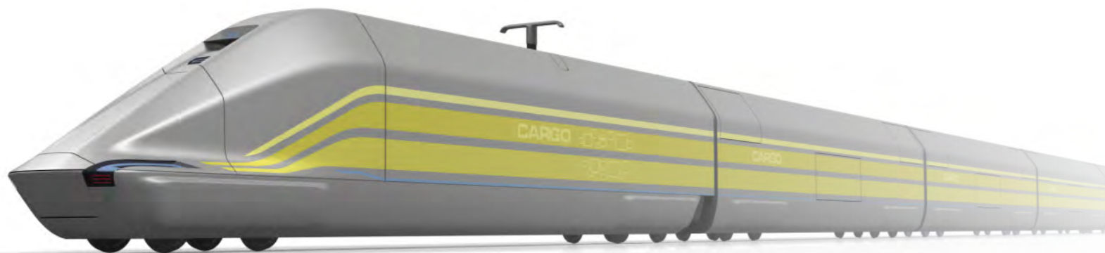
NGT-Cargo-Triebkopf mit Einzelwagenanhängern und automatischer Kupplung
