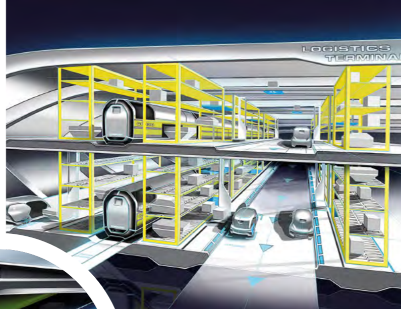
Regallager im Logistics-Terminal-Konzept sind entlang der Zugwagen positioniert. Güter werden automatisch vorsortiert und direkt am Gleis zwischengelagert.
