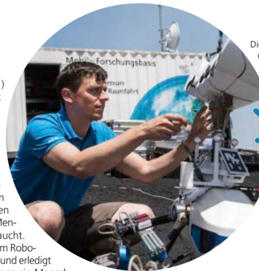
Die letzten Vorbereitungen im Basecamp am Ätna – dann legt Roboter LRU1 los. In seinem Kopf befinden sich mehrere Kamerasysteme. Mit den Filterrädern ganz außen nimmt er zum Beispiel unterschiedliche Frequenzbereiche wahr.
