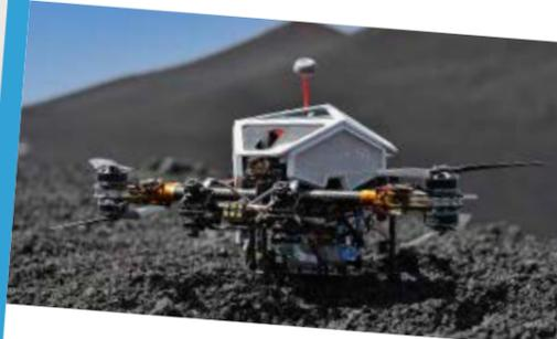
Ardea ist ein Micro Aerial Vehicle (MAV), hat vier Kameras mit Ultra-Weitwinkel-Objektiven, die in vertikaler Richtung einen Bildbereich von 240° abdecken. Damit kann Ardea zugleich den Boden und die Decke sehen, was das Navigieren und Kartieren in engen Räumen, wie beispielsweise Höhlen, deutlich vereinfacht.
