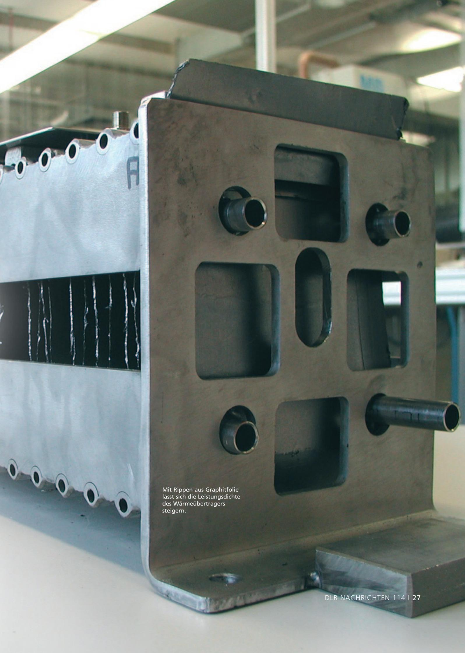
Mit Rippen aus Graphitfolie lässt sich die Leistungsdichte des Wärmeübertragers steigern.
