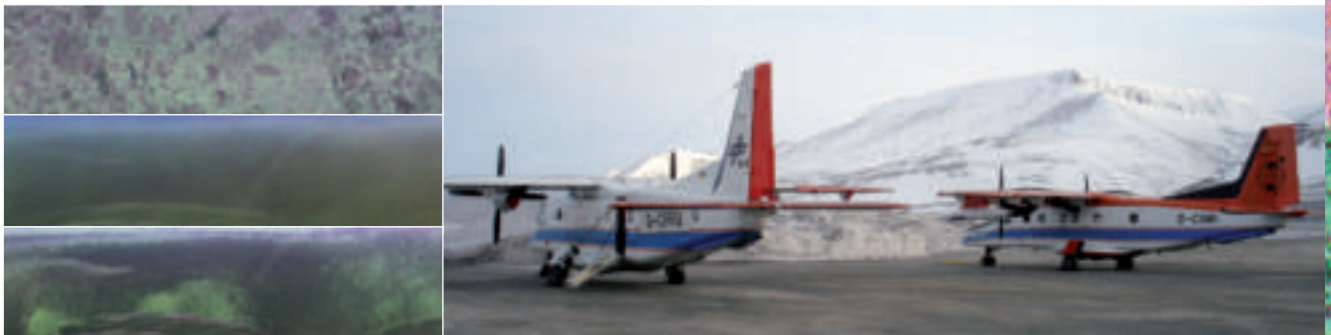
Radarbilder in Falschfarben-Darstellung von Meer-Eis (oben) und Land-Eis mit 23 Zentimeter Wellenlänge (Mitte) sowie 85 Zentimeter (unten). Die Bilder in der Mitte und unten zeigen dasselbe Gebiet. Unterschiedliche Signaturen sind speziell auf Grund der sehr guten Eindringung bei 85 Zentimeter Wellenlänge zu sehen. Das rechte Bild zeigt die zwei beteiligten DLR-Forschungsflugzeuge am Flughafen von Longyearbyen
