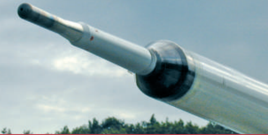
5-Loch-Sonde am Nasenmast zur hochgenauen Messung von Anströmgeschwindigkeit und -richtung
