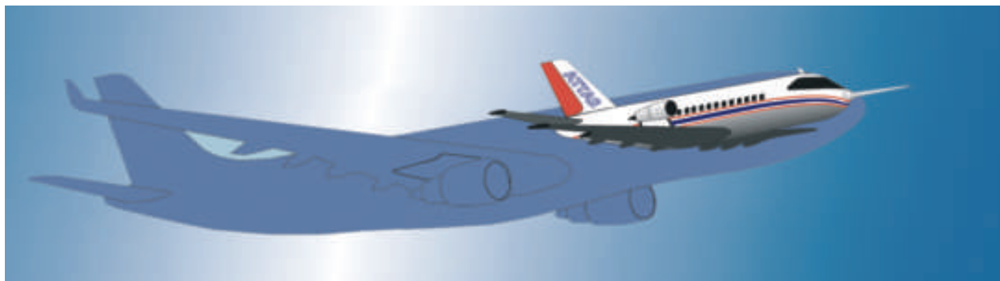
Der fliegende Simulator ATTAS kann das Verhalten eines gesamten Flugzeugs in allen Freiheitsgraden wiedergeben. So lassen sich unterschiedliche Flugzeugtypen imitieren, in dieser Darstellung beispielsweise ein großes Verkehrsflugzeug wie der A3XX
