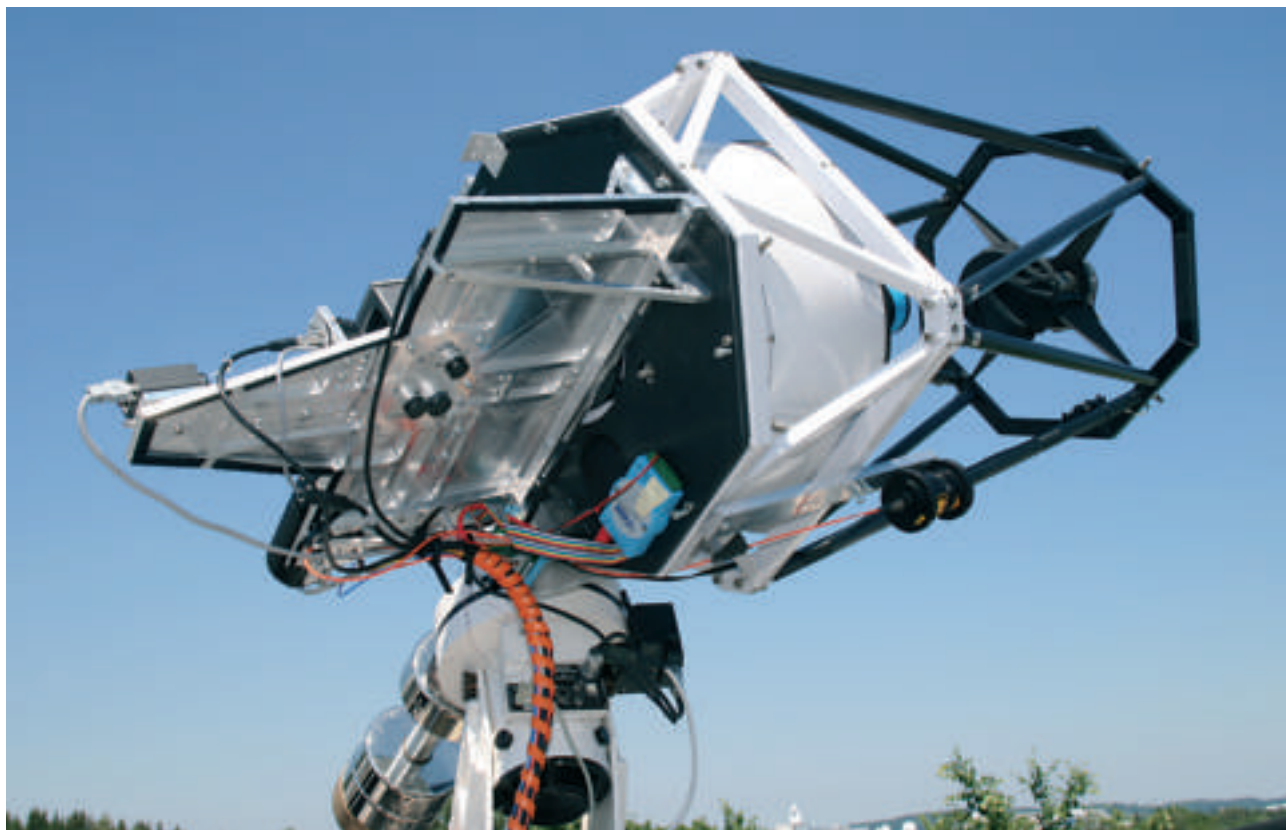
Das KIODO-Empfangsterminal – ein 40 Zentimeter Cassegrain-Teleskop mit fokalen Messgeräten und optischem Receiver-Frontend – in der optischen Bodenstation Oberpfaffenhofen
