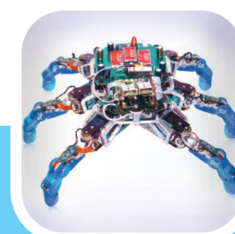
Eine 6-beinige Laufmaschine auf Basis der Finger in den Roboter-Händen
