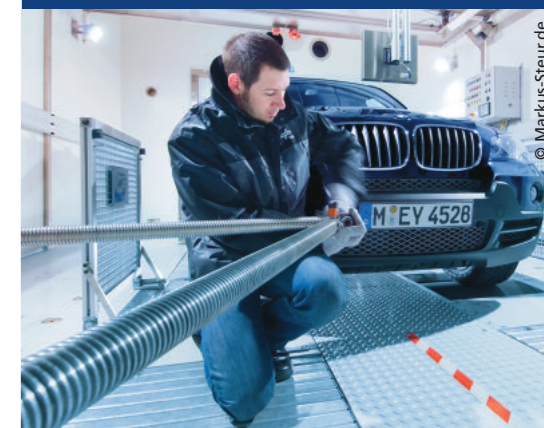
Eine spezielle hochflexible Montageeinrichtung des Vier-Motoren-Allradrollenprüfstandes gewährleistet eine fehlerfreie Krafteinleitung
