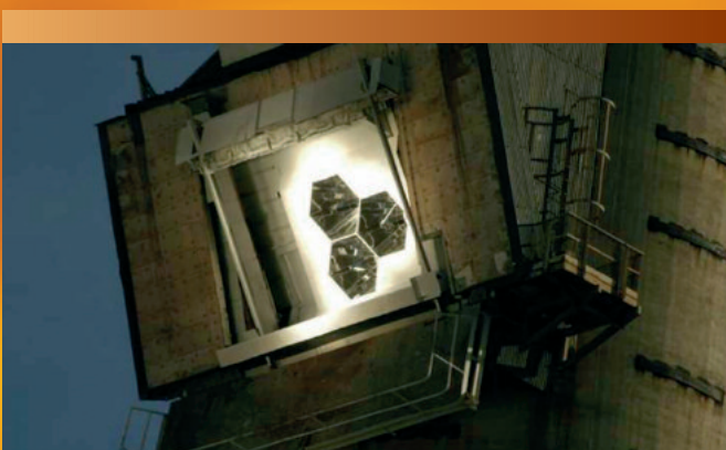
Detailausschnitt des Receiverclusters eines solarhybriden Testsystems im Betrieb.
