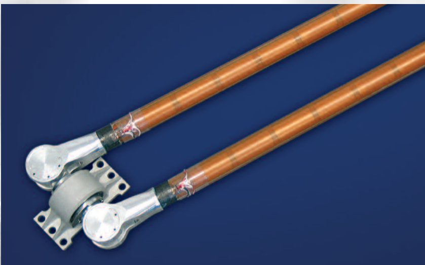
Gelenkkette des Parallelroboters TRIGLIDE mit zwei aktiven Stäben, die außen mit Piezofolienmodulen beklebt sind
