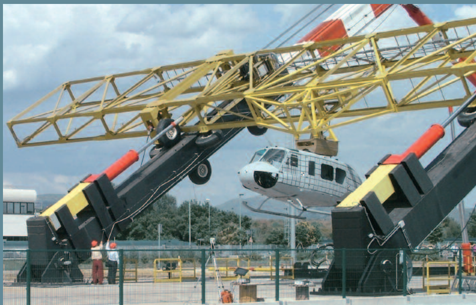
Vorbereitung des Hubschrauber-Crashtests auf der Versuchsanlage des italienischen Luftfahrtzentrums CIRA (Centro Italiano Ricerche Aerospaziali)
