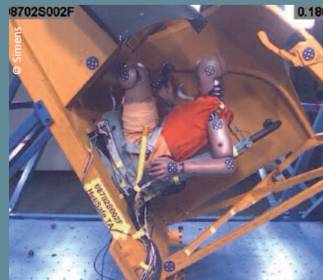
Vergleich der MADYMO Simulation (links) mit dem Cockpit-Schlittentest (rechts), 180 Millisekunden nach dem Aufprall
