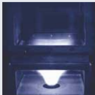
Blick durch die Druckscheiben der Brennkammer auf die Flamme des Brenners
