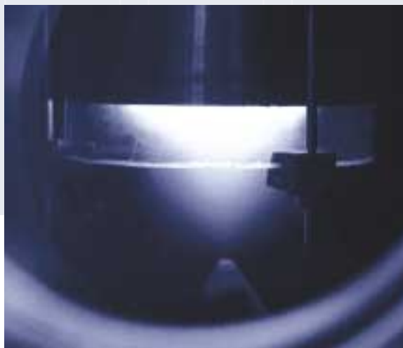
Experimentelle Flamme zur Erzeugung von Nanopartikeln
