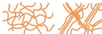
Polymere Molekülketten (z. B. Gummi) im entspannten und gespannten Zustand
