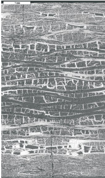
Gradiertes C/C-SiC Werkstoff. Hochfester, bruchzäher Kernbereich kombiniert mit extrem verschleißfester Außenschicht mit hohem SiC-Gehalt.
