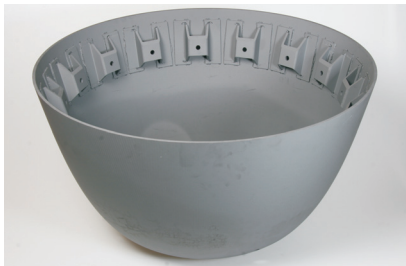
C/C-SiC Nasenkappe für die Raumkapsel EXPERT mit den 16 innen befestigten CMC-Krafteinleitungen
