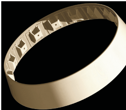
CT-Übersichtsaufnahme zur Anordnung der Krafteinleitungen (3D, Falschfarbe)
