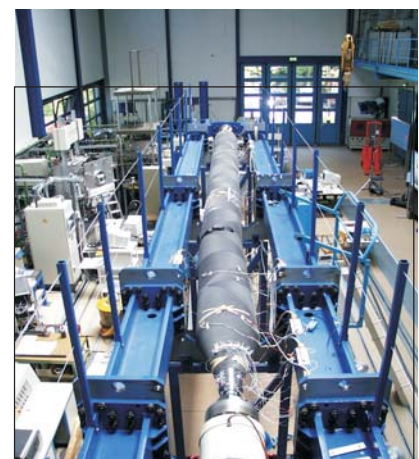
Restfestigkeitsversuch eines 10 m langen CFK-Rohres der CargoLifter-Gitterstruktur
