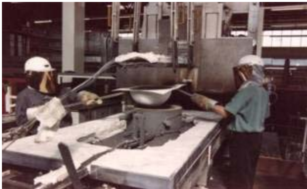
SPF- Aluminium AA 5083-SPF, T_{SPF} \approx 480^{\circ}\text{C}
