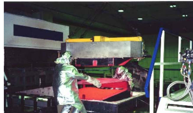
SPF-Titanium TiAl6V4, AMS 4911, T_{SPF} \approx 900^{\circ}\text{C} ,
