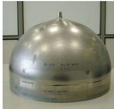
Spingeformter Dom (Ø 660 mm) Wandstärke= 0,7 mm
