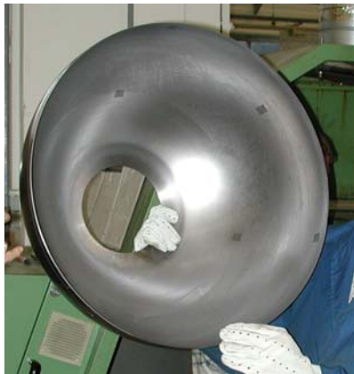
Spingeformter Dom (Ø 660 mm) Wandstärke= 0,7 mm
