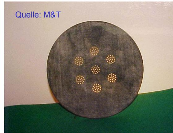
**Rohrboden und Siebplatte für Reaktoren**
