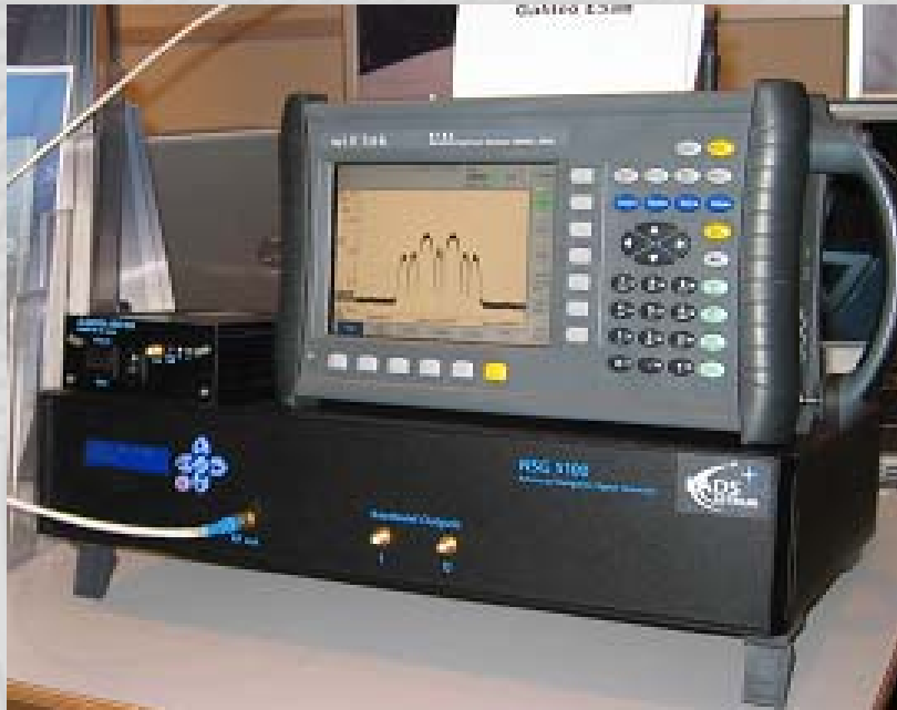
NSG-5100 Signalgenerator und Spectrum Analyzer mit GALILEO Signal
