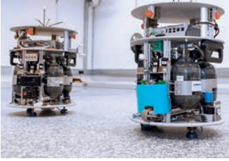
Test von Steuerungssystemen für das Docking von Raumfahrzeugen im Labor TEAMS
