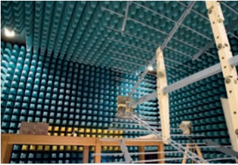
Elektromagnetische Verträglichkeit (EMV) wird für jedes System geprüft, auch Prüfungen gemäß üblicher EMV-Normen für Alltagsgeräte werden durchgeführt
