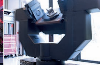
Vermessung und Kalibrierung von Trägheitssensoren zur Navigation von Raumfahrzeugen im GPS/INS-Labor
