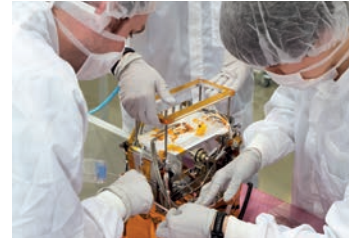
Integration der Elektronikbox des Asteroiden-Landers MASCOT
