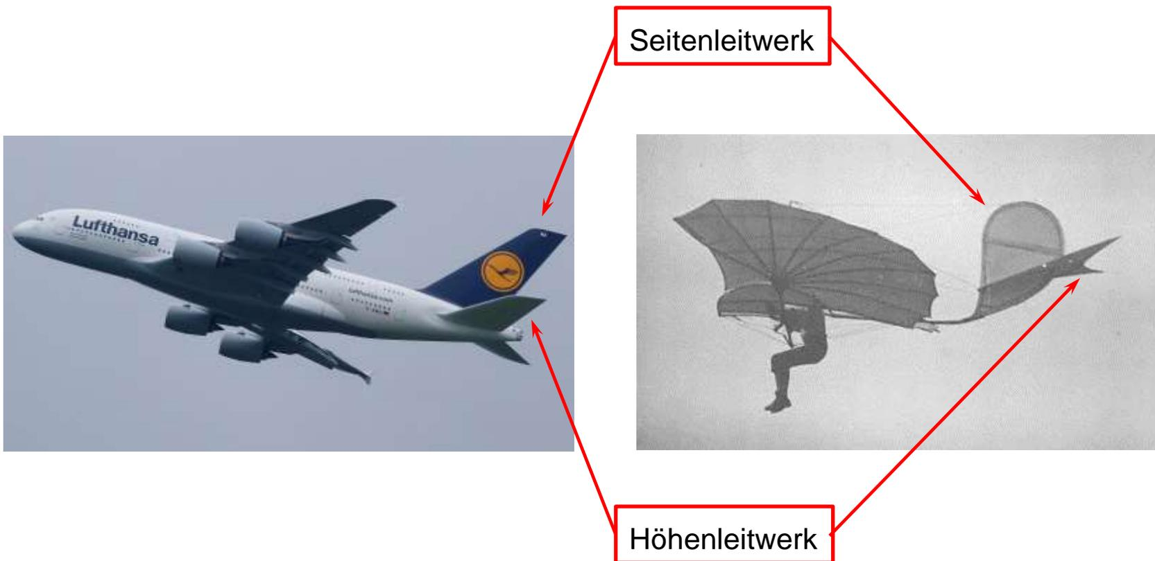
Für Flugfähigkeit besonders wichtig: Stabilität um die Querachse (Längsstabilität)
