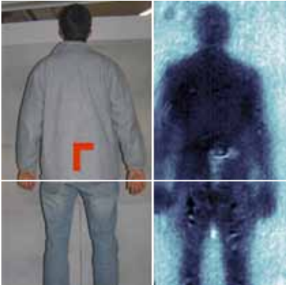
Radiometrische Abbildung um 90 Gigahertz von einer Person mit versteckter Schusswaffe im Innern eines Gebäudes (in der Fotografie rot angedeutet)
