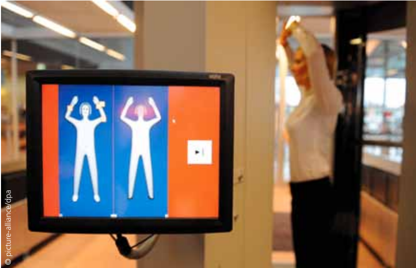
Sicherheitskontrolle mit einem Millimeterwellen-Personenscanner: Verdächtige Objekte, die mittels eines Bilderkennungsprogramms bei der Person im Hintergrund identifiziert werden, sind auf dem Monitor anhand eines schematischen Körperprofils gezeigt
