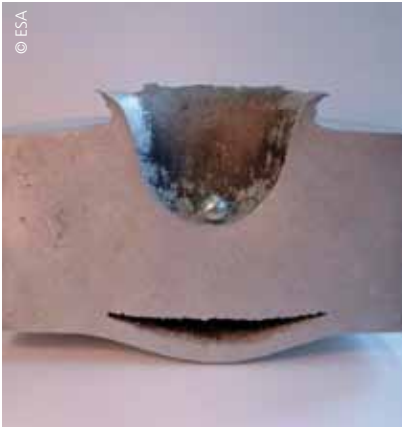
Simulierter Einschlag einer zwölf Millimeter großen Kugel in eine acht Zentimeter dicke Aluminiumplatte. Die Geschwindigkeit betrug sieben Kilometer pro Sekunde.
