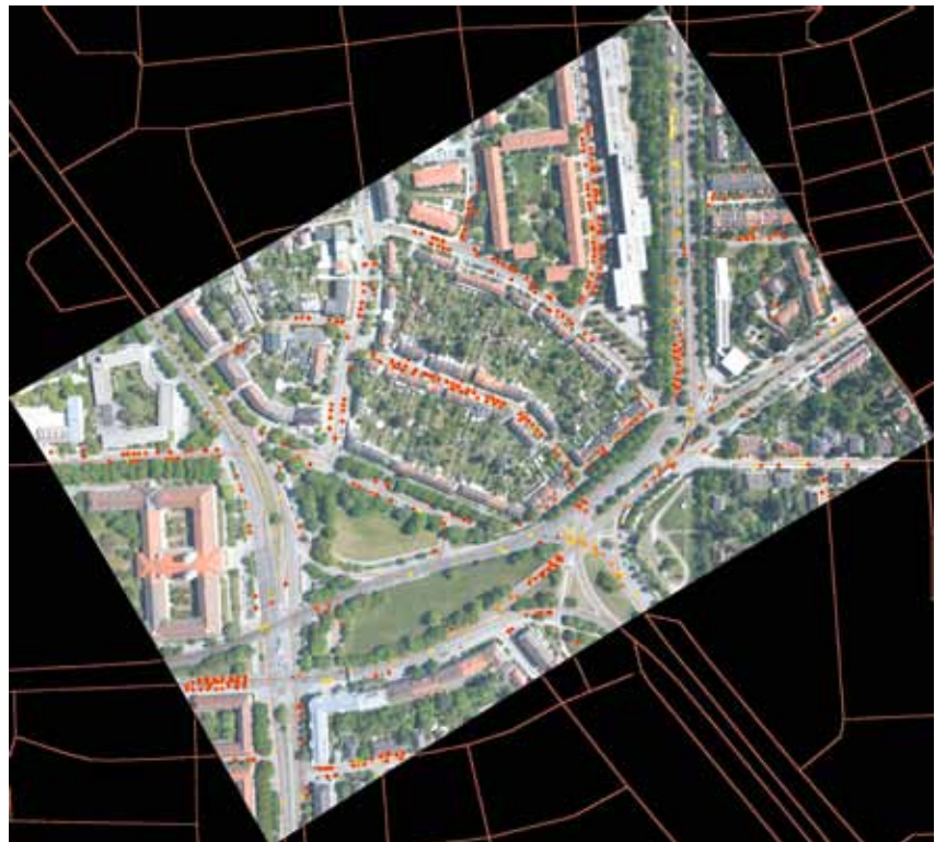
Aufnahme einer Straßenkreuzung in München mit dem DLR-3K-Kerasystem aus 1.000 Metern über Grund. Die farbigen Punkte stellen automatisch detektierte Fahrzeuge mit deren Geschwindigkeiten dar. Die Geschwindigkeit ist als Farbe codiert, von rot als stehender Verkehr bis grün für schnell fließenden Verkehr.
