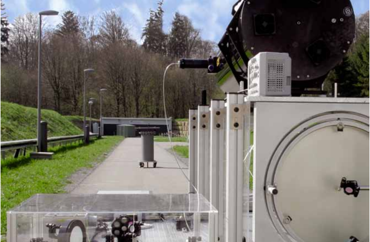
Test unter freiem Himmel: Experiment mit lasergestütztem Stand-off-Detektionssystem auf der DLR-Laserfreistrahlstrecke in Lampoldshausen
