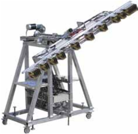
Fotografie des ANSAS-Systems mit multi-spektraler zweidimensionaler Abbildungsfähigkeit durch kombiniertes elektronisches und mechanisches Abtasten
