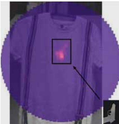
Terahertz-Bild (farbig) einer von einem T-Shirt verdeckten Waffenattrappe. Das Terahertz-Bild wurde dem visuellen Bild der gleichen Szene überlagert (schwarz-weiß). Die Waffenattrappe war 18 Meter vom Terahertz-Scanner entfernt.
