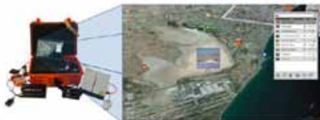
Alle Komponenten des Disaster Management Tool (DMT) passen in eine handgepäcktaugliche Box. Ortsbezogene Informationen werden auf einer übersichtlichen Kartenansicht angezeigt.
