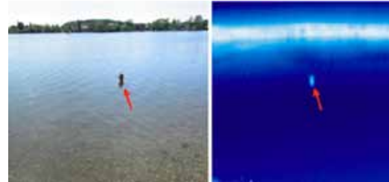
Ein Schwimmer, von dem nur der Kopf aus dem Wasser ragt, ist klar detektierbar (rote Pfeile)
