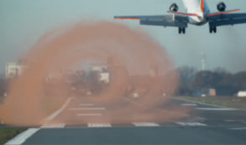
Visualisierung einer Wirbelschlepe des ATTAS am Forschungsflughafen
