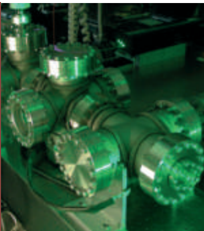
Modulare Ultrahochvakuumkammer für Langzeittests von Laseroptiken
