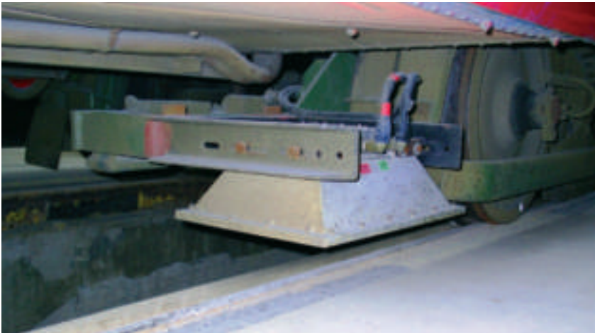
Der Wirbelstrom-Sensor unter dem Zug sorgt für das Erkennen der Weiche
