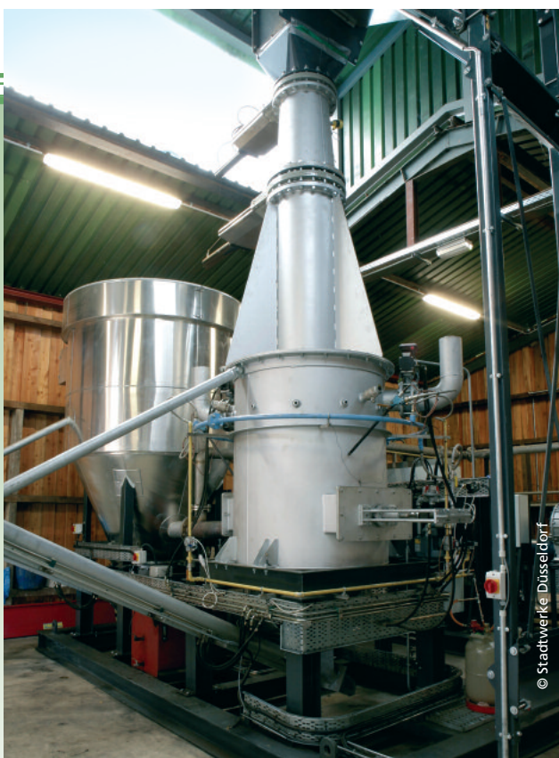
Alternative Brenngase aus festen Brennstoffen zu gewinnen, ist heute hochwillkommen – Pilotanlage einer fortschrittlichen Holzvergasung der EnBW-Beteiligung Stadtwerke Düsseldorf im sauerländischen Arnsberg.
