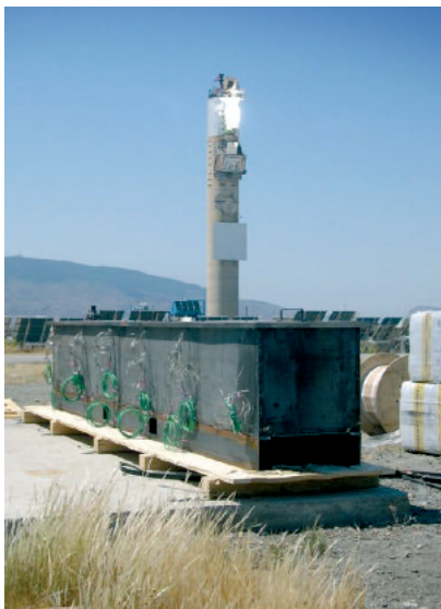
Latentwärmespeicher vor der Integration in die Parabolrinnen-Testanlage auf der Plataforma Solar de Almería.
