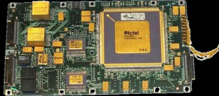
Instrumentensteuerung mit FPGA
