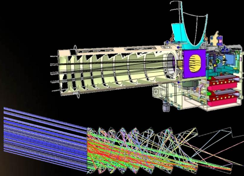
Leichtbaublende aus Elektroformteilen
