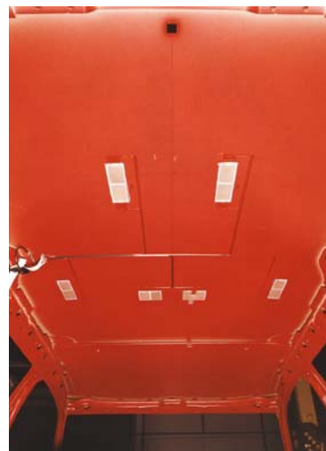
Bild 16: PKW-Dachblech mit applizierten Funktionsmodulen
