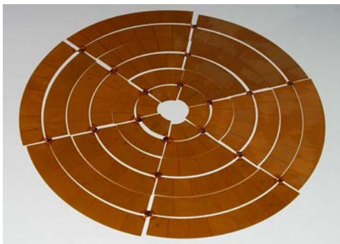
Bild 14: oben: Spezielles Funktionsmodul für den adaptiven Reflektor; unten: 36 Segmente für eine Deckschicht des adaptiven Reflektors
