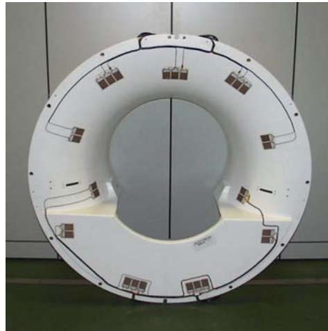
Bild 15: Verkleidungskomponente eines MRT mit applizierten Funktionsmodulen
