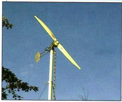
Abbildung 3: DLR Windrotor mit gewickelten 2,5-m-Blättern
