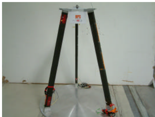
Bild 8: Aktives Dreibein nach den Tests
