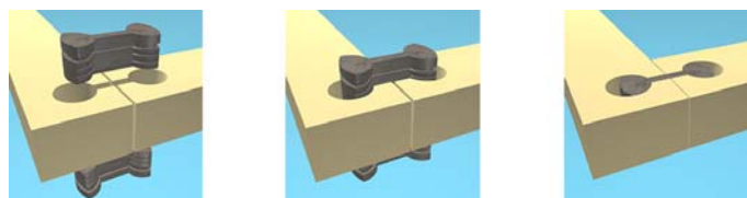
Abb. 11: Funktion des Verbinders 'junctio'
