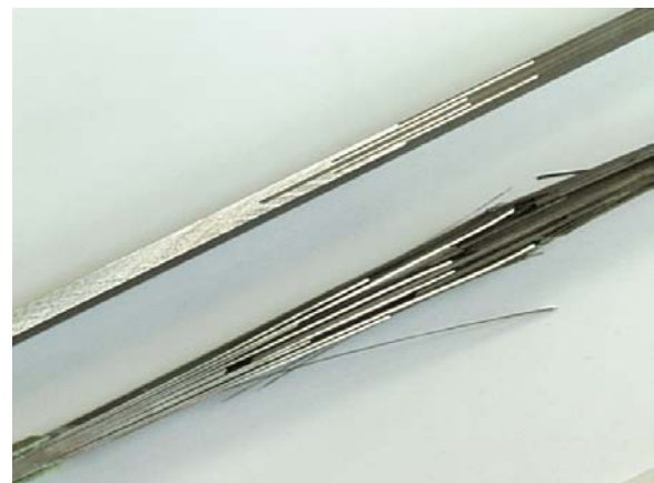
BILD 15: Lamellenanschlussprobe vor und nach dem Bruch
