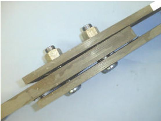
Bild 15: Versagensform bei dynamischer Belastung - Bolzenbruch
