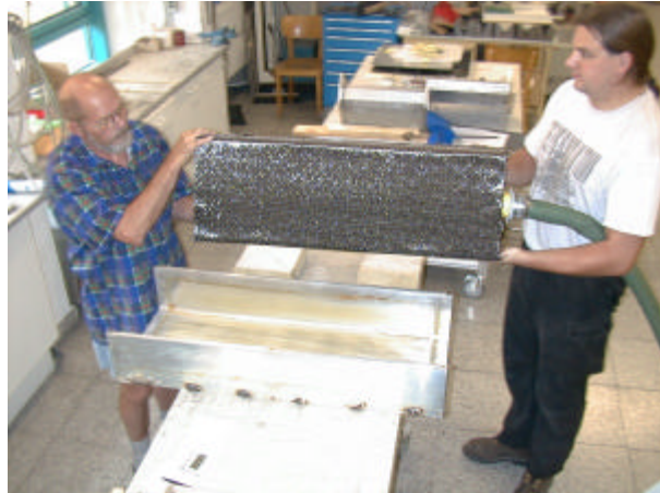
Abb.: 6: Einlegen der Multiaxialgeleges mit der Trägervorrichtung in das Fertigungsmittel
