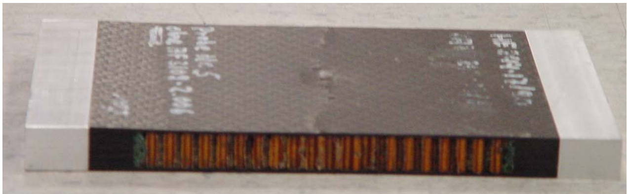
CFK-Sandwich-Testkörper mit Nomex-Waben, Dicke HE 244-17 / 90
