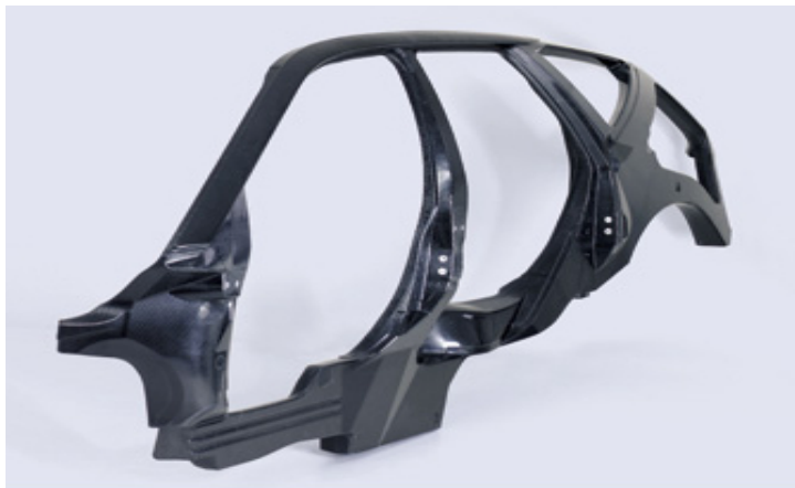
CFK-verstärkter Seitenrahmen, Quelle: BMW
