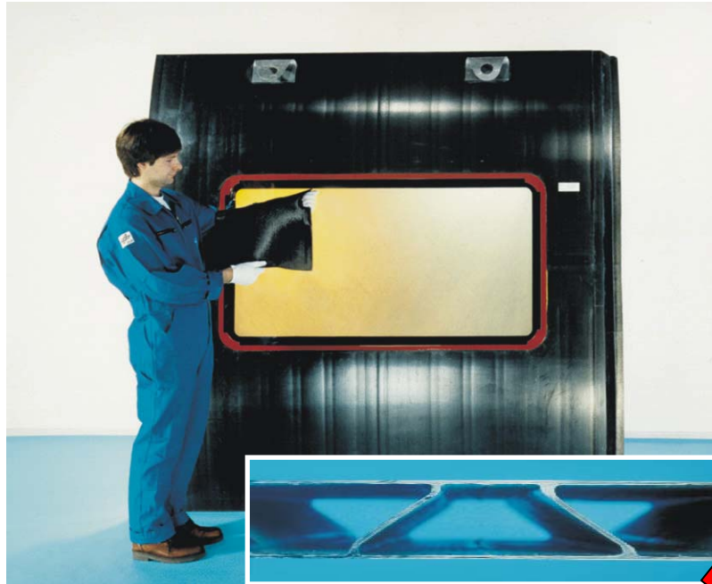
Fertigungsstudie: ICE-Seitenwandmodul als Flächenfachwerk
