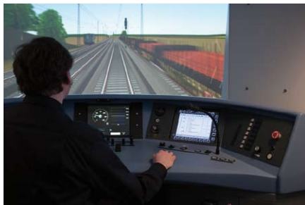
Ein Mockup mit Führerpult, Visualisierung und Sound bildet im RailSiTe die Lokführerkabine nach
