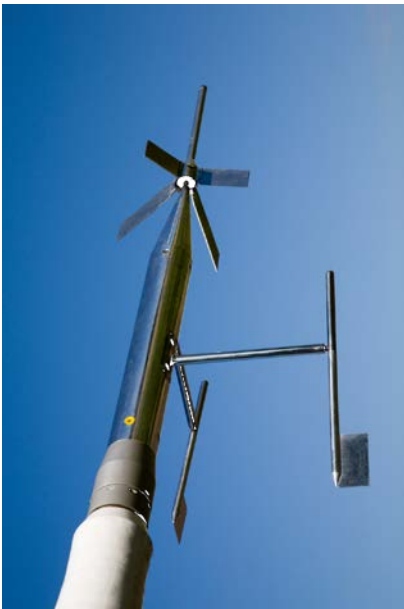
Strömungsmesssonde des Versuchshubschraubers ACT-FHS
